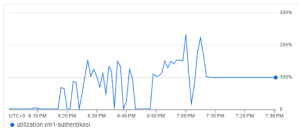
Gambar 5. Utilisasi CPU pada VM2 Selama Stress Test Proses Authentikasi Login
