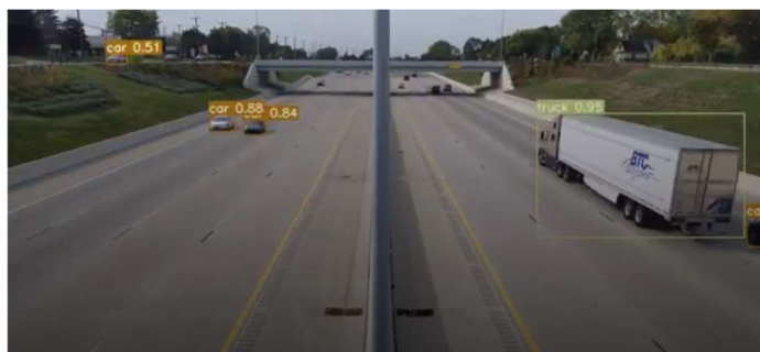
Gambar 4. Hasil video penerapan YOLOv7 dalam melakukan deteksi jenis kendaraan
