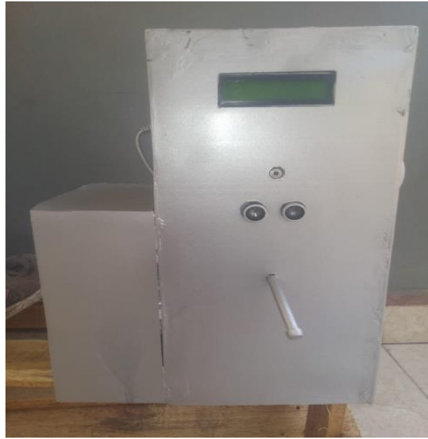
Gambar 5. Tampilan Depan Robot Pengukur Suhu Tubuh dan Penyemprotan Hand Sanitizer Otomatis Berbasis Mikrokontroler Arduino Uno
