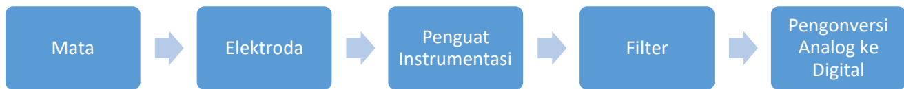
Gbr 1. Diagram blok sistem penggerak kursor menggunakan sinyal EOG
