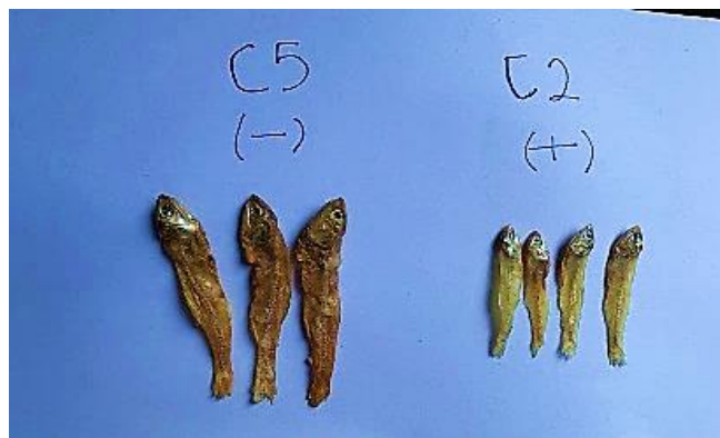
Gambar 2. Perbedaan ciri-ciri hasil laut ikan teri yang negatif (-) formalin (C5) dan positif (+) mengandung formalin (C2)
